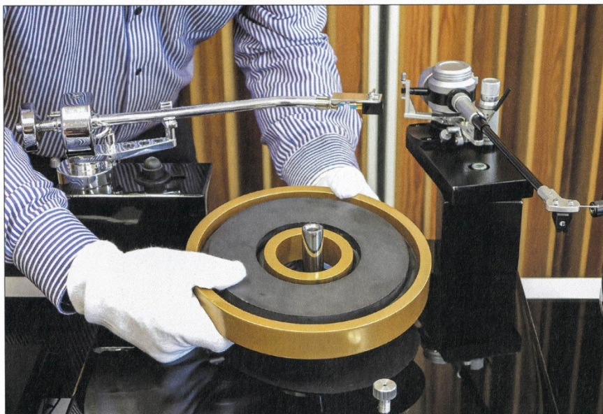
Der untere, in Gusseisen eingefasste Magnetring, der den Teller „trägt“, wird um eine Schelle, die die Lagerachse einfasst, auf einer dünnen Lage Filz platziert und ist selbstzentrierend.
