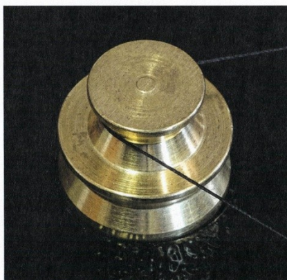
Das aus Messing gefertigte Motor-Pulley hält per dünnem String den 16-Kilo-Teller in Schwung.
