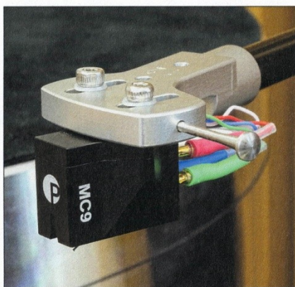
Zum optimalen Vergleich war in beiden Tonarmen ein Pro-Ject MC9 justiert.
