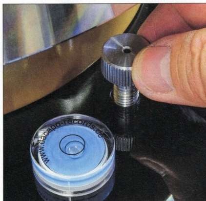
Mittels der Federbolzen lässt sich die Platine Verdier exakt waagrecht ausrichten.
