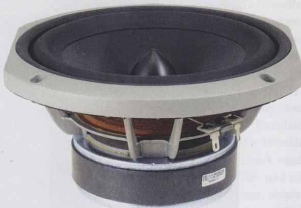
Der Konus mit druckgepresstem Alu-Korb ist mit seiner leicht gebauten Membran-/Schwingspuleneinheit und dem kräftigen Antrieb ein Zwitter aus Mitteltöner und kraftvollem Bass. Ebenso ist die Staubschutzkalotte in Phaseplug-Form gehalten und stabilisiert zugleich.
