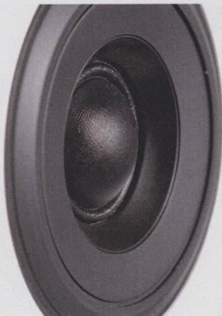
Statt Horn und Titankalotte kommt eine Seidenkalotte im großen 28-mm-Format zum Einsatz. Der Waveguide erhöht den Wirkungsgrad und bringt hornähnliche Dynamik ohne Druckkammer, kann wegen der hohen Trennfrequenz aber recht kurz ausfallen.
