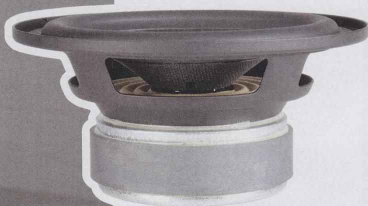
Der Antrieb ist auf Dynamik gezüchtet, der Blechkorb auf überschaubare Herstellungskosten. Die Inverskalotte aus hartem Spezialpapier koppelt über den kleinen Subkonus an die Schwingspule an.
