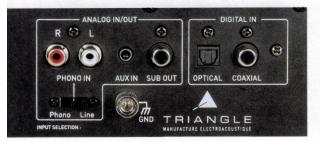
Der Stereo-Cinch-Eingang der Triangle kann mit einem kleinen Schalter zwischen Phono und Line umgeschaltet werde.
