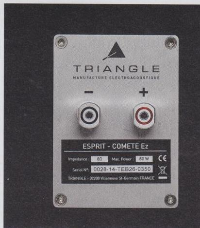
Das hochwertige Anschlussfeld und die soliden Polklemmen aus gebürstetem Aluminium unterstreichen den hohen Anspruch der Esprit-Ez-Serie. Ein selbstverriegelnder Steckmechanismus sorgt dafür, dass Bananenstecker sicher gehalten werden.
