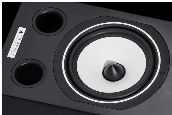
Der Tiefmitteltöner hat einen Durchmesser von 165 Millimetern und wurde ebenfalls für die Serie weiterentwickelt; seine weiß gefärbte, in einer weichen Rundsicke aufgehängte Membran und die Staubschutzkappe werden aus Zellulosebrei hergestellt. Während diesem Naturmaterial gern eine für den Einsatz in Mitteltönern ideale Klangcharakteristik attestiert wird,
