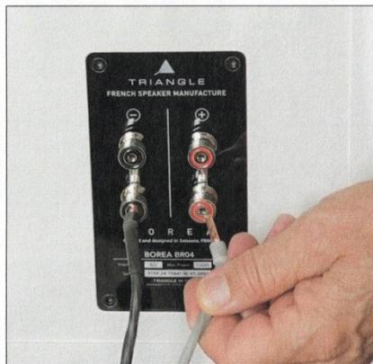
**Das Bi-Wiring-Terminal ist stabil und kann Bananenstecker und Kabelschuhe aufnehmen.**
