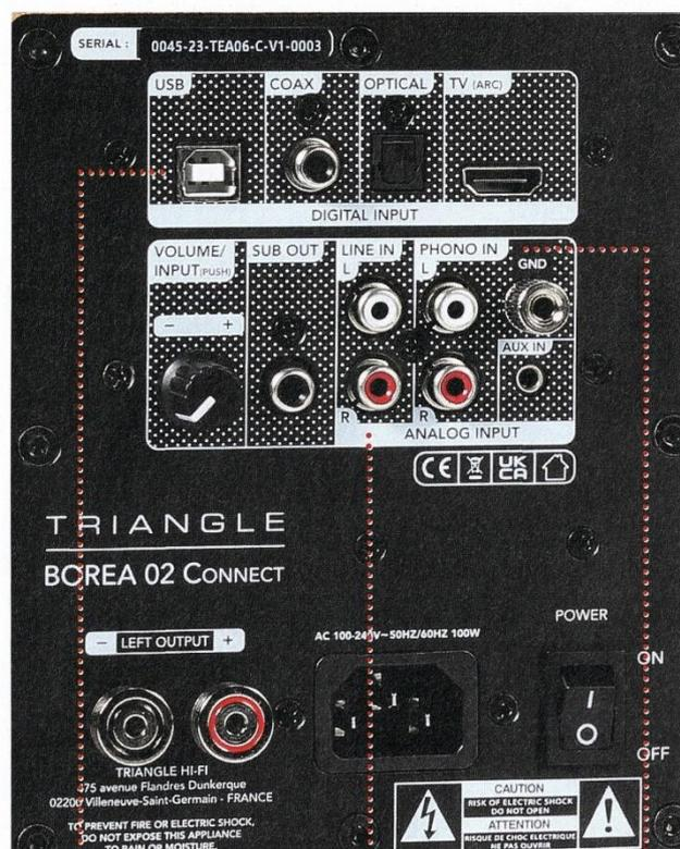
**USB:** USB ist die meist für Computer bevorzugte Verbindungsart und ermöglicht theoretisch die höchsten Auflösungen.
