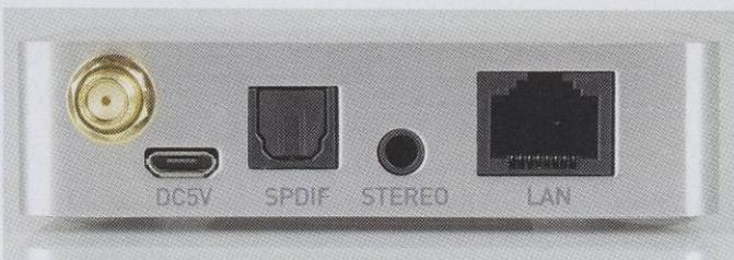
Das AIO C besitzt neben Bluetooth-Konnektivität einen optischen Digital-Eingang und eine Miniklinken-Buchse für analoge Quellen, die sich dann auch in Stereo über zwei AIO 3 wiedergeben lassen.
