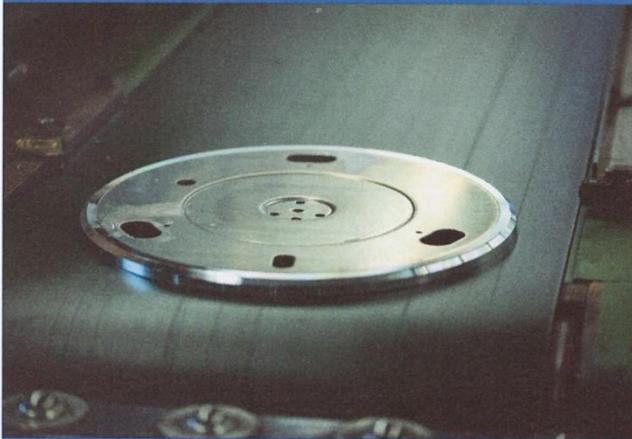
Der Aluminium-Teller auf dem Fließband. In einem weiteren Arbeitsschritt wird er von Rekkord definiert mit Kunststoff bedämpft.
