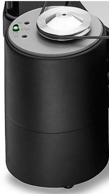
*Der Motor ist konsequenterweise ausgelagert und hat keine direkte Verbindung zum Plattenspieler. Seine Elektronik wird mit Gleichspannung versorgt und ist so ausgelegt, dass alle notwendigen Versorgungsspannungen für den Synchronmotor mit Hilfe eines integrierten Sinusgenerators komplett neu erzeugt werden.*
