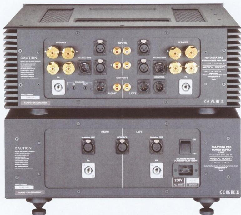
**Ungewöhnlich zahlreiche Anschlussmöglichkeiten an der Endstufe – allein fünf Kabel für die Verbindung zum Netzteil**
