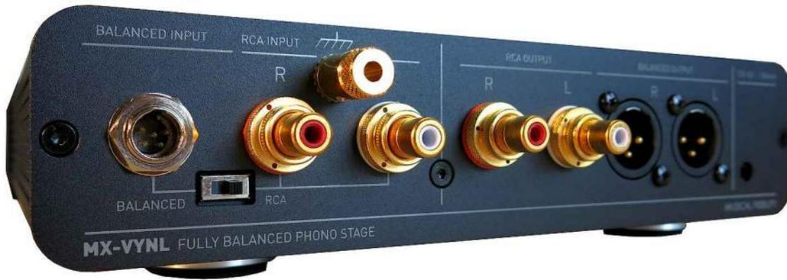
Auf der Geräterückseite von links der Mini-XLR Eingang, der Umschalter für XLR bzw. Cinch, die Erdungsklemme, der Cinch- sowie XLR Ausgang und rechts dann der Stromanschluss mit 12 Volt für das Steckernetzteil.
