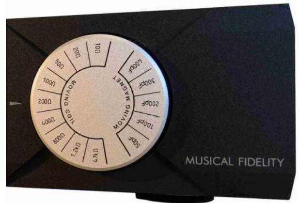
Die Umschaltung zwischen MM- und MC-Tonabnehmern erfolgt wunderbar bequem mit dem silbergrauen Drehrad auf der rechten Vorderseite. Toll gelöst das Umschalten, da alles per Relais umgesetzt wird. Am Drehrad hat man die Wahl zwischen 5 Abschlusskapazitäten für MM sowie 9 Widerständen bei MC. Die unterschiedlichen Verstärkungsfaktoren von MM und MC werden nicht
