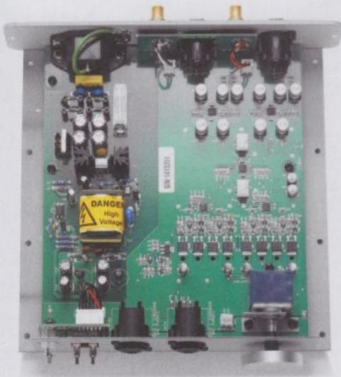
**FEINKOST** Das Schaltnetzteil wurde sehr aufwändig aufgebaut, die Schaltung ist vollsymmetrisch Class A.
