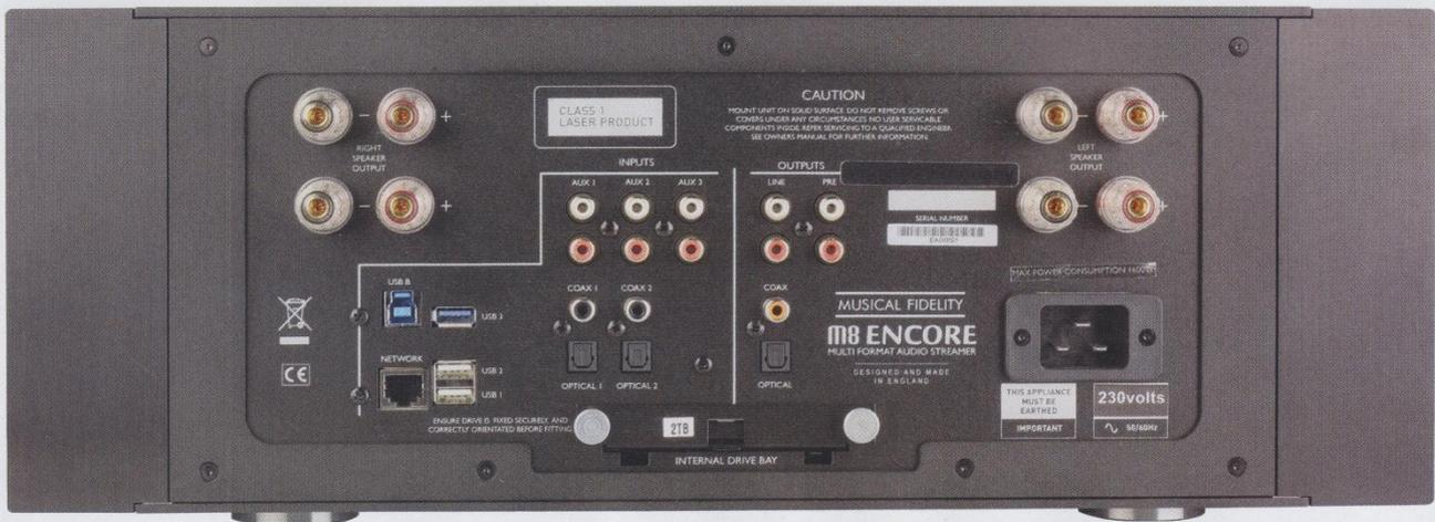
Je zwei Paar Lautsprecherklemmen ermöglichen Bi-Wiring der genutzten Lautsprecher. Ein- und Ausgänge sind auf der Rückseite klar getrennt
