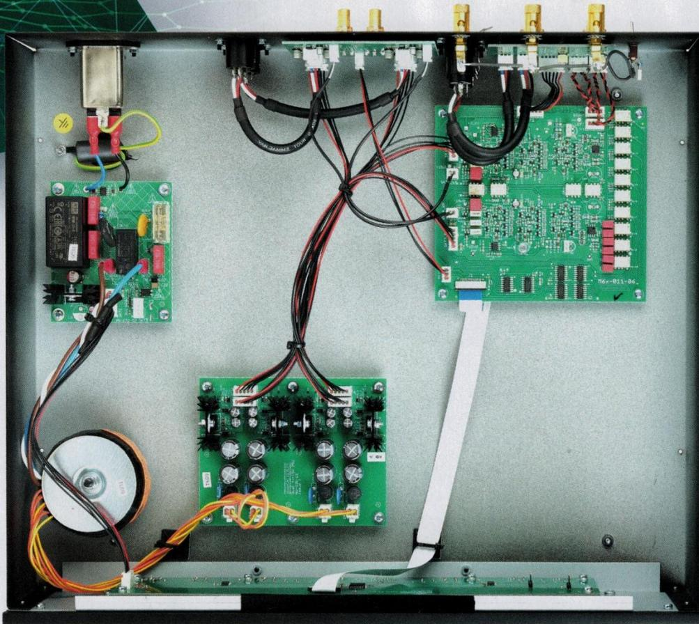
Der deutlich höhere Schaltungs- und Bauteileaufwand eines vollandiskret realisierten Phonoverstärkers schlägt sich erkennbar nieder. Praktisch: Das Betriebssystem merkt sich die Einstellungen für jeden Eingang. Auffällig am M6x ist ein etwas erhöhter Rauschpegel via Moving-Coil-Eingang, der eher die Nutzung normaler MCs anstatt extrem leiser und sehr niederohmiger Abtaster nahelegt.
