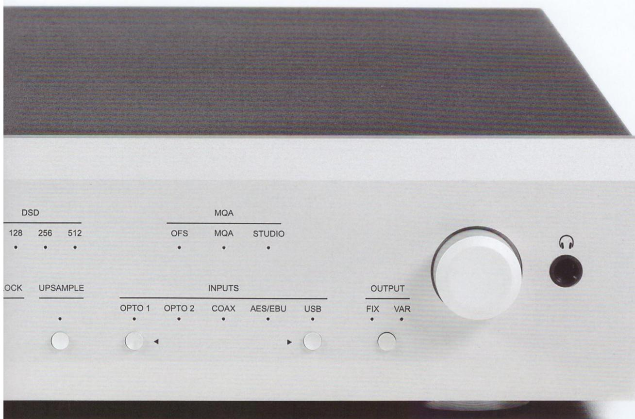
ist das Gehäuse groß und majestätisch: Hinter der oben wie unten ab-geschrägten Aluminiumfront geht es stolze 30 Zentimeter in die Tiefe. Genug Platz also auf der Platine und drumherum, um Bauteile und Schaltungen angemessen weit entfernt voneinander zu platzieren.
