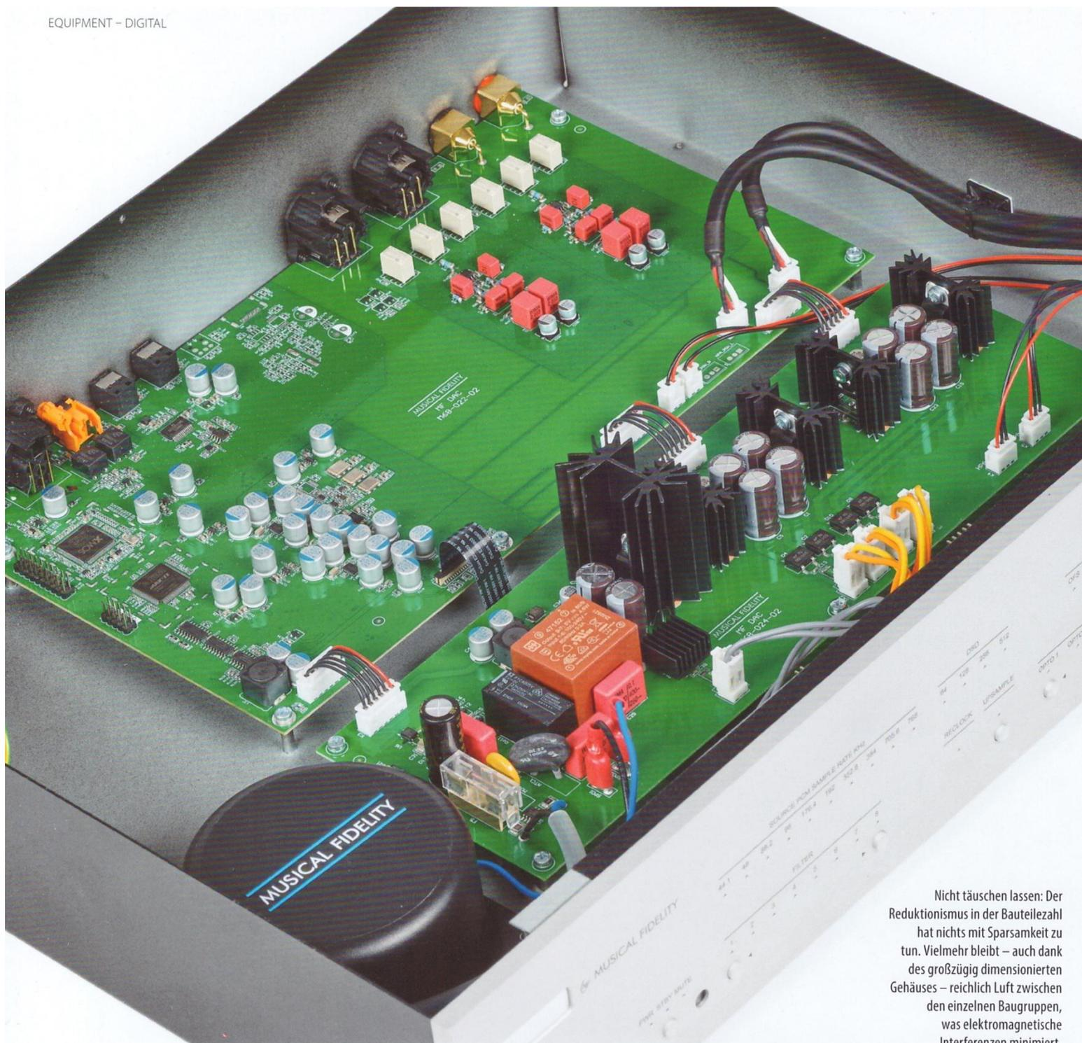
Nicht täuschen lassen: Der Reduktionismus in der Bauteilezahl hat nichts mit Sparsamkeit zu tun. Vielmehr bleibt – auch dank des großzügig dimensionierten Gehäuses – reichlich Luft zwischen den einzelnen Baugruppen, was elektromagnetische Interferenzen minimiert.
