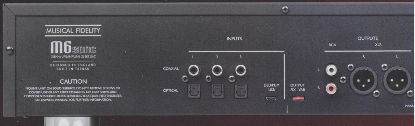
Der M6s DAC ist für einen reinen D/A-Wandler relativ großzügig ausgestattet, was ihn fast schon zu einer digitalen Vorstufe macht. Der analoge Ausgangspegel ist zwischen fest und variabel schaltbar, was ihn flexibel im Umgang mit Vollverstärkern und Endstufen macht
