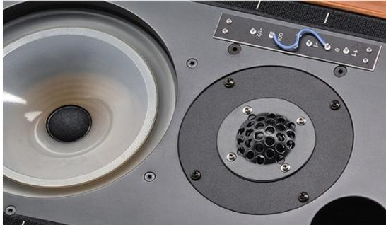
*Der Hochtonepegel kann in mehreren Schritten an Raum und Hörgeschmack angepasst werden. Jedoch ist ein Neuverlöten der Kontakte erforderlich! In diesem Punkt hätte die Akribie bei der Erfüllung der originalen Vorgaben der BBC weniger streng ausfallen dürfen.*
