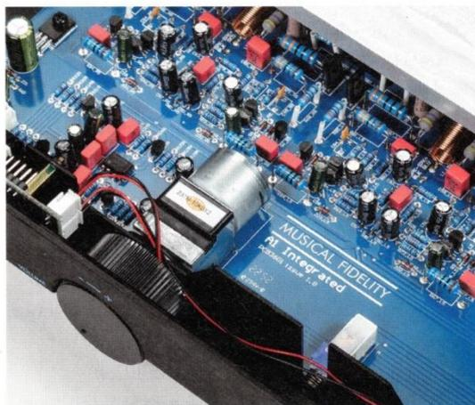
**Der zur Fernbedienbarkeit unerlässliche Elektromotor macht aus dem Potentiometer zur Lautstärkeregelung ein Motorpoti. Die Platine zeigt „Version 1.5“ des A1.**
