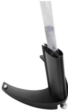
Um die Stabilität weiter zu steigern kann auf Wunsch der Vertikalträger, der der Länge nach in vier Kammern unterteilt ist, mit resonanzminderndem Material befüllt werden. Hierfür gibt es passende PVC-Schläuche, die mit Ballastkugeln gefüllt werden können. Dies erhöht das Gewicht des Systems aus Lautsprecher und Stativ um weitere 4 kg und senkt den Schwerpunkt ab.
