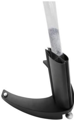
Um die Stabilität weiter zu steigern kann auf Wunsch der Vertikalträger, der der Länge nach in vier Kammern unterteilt ist, mit resonanzminderndem Material befüllt werden. Hierfür gibt es passende PVC-Schläuche, die mit Ballastkugeln gefüllt werden können. Dies erhöht das Gewicht des Systems aus Lautsprecher und Stativ um weitere 4 kg und senkt den Schwerpunkt ab.
