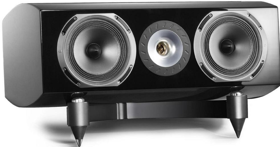
Die leichte Neigung nach hinten sorgt für einen optimalen Abstrahlwinkel zum Hörplatz. Die höhenjustierbaren Spikes gleichen eventuelle Bodenunebenheiten aus. Die massive Konstruktion aus matt schwarz lackiertem Stahl erstickt jegliche Neigung zu Resonanzen im Keim.
