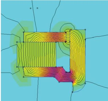
Das spezifische Profil der Magnetpolschuhe und der enge Magnetspalt wurden weiter optimiert und garantieren eine lineare Bewegung der Spule in allen Belastungsbereichen.
