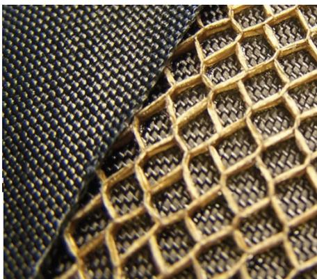
Das Sandwich besteht aus drei Schichten. Eine innere Wabenstruktur aus Zellstoff wird außen jeweils von Glasfaser ummantelt. Dieses Prinzip verleiht der beweglichen Baugruppe ein optimales Masse-, Dämpfungs- und Steifigkeitsverhältnis. So konnte das Entwicklungsziel, eines Chassis mit geringsten Verzerrungen bei gleichzeitig hohen Belastungsreserven erreicht werden: starke Auslenkungen ohne Membranverformung.
