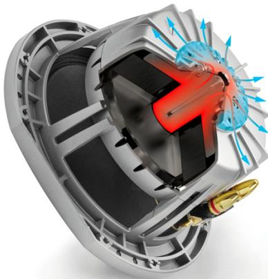
Zusätzlich verfügt der T16GMF100 über einen Wärmeübertragungsring, der an der Rückseite des Antriebs platziert ist. Dieser ermöglicht eine perfekte und effektive Wärmeableitung vom inneren Bereich des Magneten an den Korb des Chassis und verbessert um über 10% die Belastbarkeit des Wandlers.
