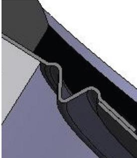
Die asymmetrisch geformte Membransicke besteht aus Textilfasern, die mit Latex imprägniert sind. Die so geformte Wellenstruktur eliminiert jegliche Fraktionierungen und Nichtlinearitäten. Die unglaubliche Leichtigkeit der beweglichen Teile erlaubt es dem T16GMF100, höchste Geschwindigkeiten ohne Kompressionseffekte zu erreichen, und verleiht ihm eine unvergleichliche Klangtransparenz.
