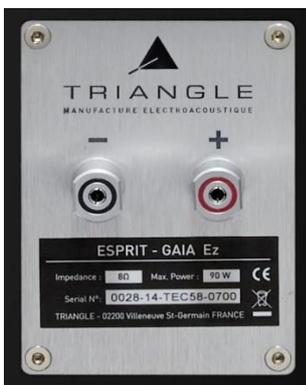
Das Anschlussterminal der Gaïa EZ ist aus antimagnetischem Aluminium gefertigt. Die Anschlussbuchsen nehmen Kabelschuhe, 4-mm-Stecker oder auch blankes Kabel auf. Zur Steigerung der Kontaktsicherheit bei Verwendung von 4-mm-Steckern (auch Bananenstecker genannt) können diese durch Anziehen der Mutter arretiert werden.
