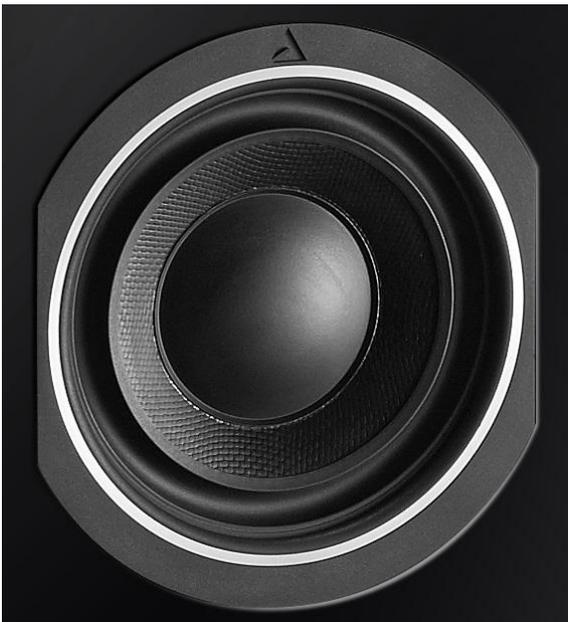
Die Membran selbst ist aus glasfaser-verstärktem Papier. Diese Mischung sorgt zusammen mit der NAWI-Geometrie für absolute Steifigkeit auch bei rauherer Gangart. Die Inverssicke (Wulst nach innen) und die Zentrierspinne führen das Chassis absolut sicher und kolbenförmig.
