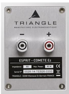
Das Anschlussterminal der Comète EZ ist aus antimagnetischem Aluminium gefertigt. Die Anschlussbuchsen nehmen Kabelschuhe, 4-mm-Stecker oder auch blankes Kabel auf. Zur Steigerung der Kontaktsicherheit bei Verwendung von 4-mm-Steckern (auch Bananenstecker genannt) können diese durch Anziehen der Mutter arretiert werden.
