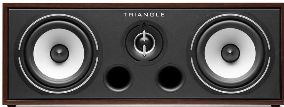
Alle Chassis sind bündig in die Front eingelassen um Schallbeugungsreaktionen zu vermeiden. Wie bei den meisten Lautsprechern von TRIANGLE üblich ist die Bassreflex-Öffnung auf der Front angebracht. Dies ist gerade beim Centerlautsprecher ein großer Vorteil. So werden keine Schallanteile nach hinten ins Medienrack hineingeworfen, die dort definitiv nichts zu suchen haben.
