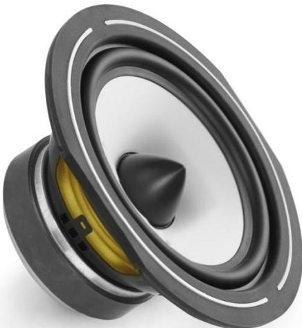
Die beiden 13cm-Tiefmitteltöner sind direkt aus der ESPRIT EZ-Linie abgeleitet und bestehen, typisch für Hochwirkungsgradlautsprecher, aus Papier. Der mitschwingende Phase-Plug sorgt für eine saubere und unter allen Bewegungsumständen gleichbleibende Abstrahlung der mittleren Frequenzen. Der sehr kräftige Magnetantrieb und die stark gespannte Zentrierspinne (im Bild gelb) sorgen für große Kontrolle. Dies entlastet schon an der Stelle der Schallentstehung den angeschlossenen Verstärker.
