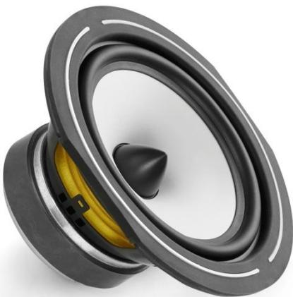
Der 16cm-Tiefmitteltöner ist direkt aus der ESPRIT EZ-Linie abgeleitet und besteht, typisch für Hochwirkungsgradlautsprecher, aus Papier. Der mitschwingende Phase-Plug sorgt für eine saubere und unter allen Bewegungsumständen gleichbleibende Abstrahlung der mittleren Frequenzen. Der sehr kräftige Magnetantrieb und die stark gespannte Zentrierspinne (im Bild gelb) sorgen für große Kontrolle. Dies entlastet schon an der Stelle der Schallentstehung den angeschlossenen Verstärker.
