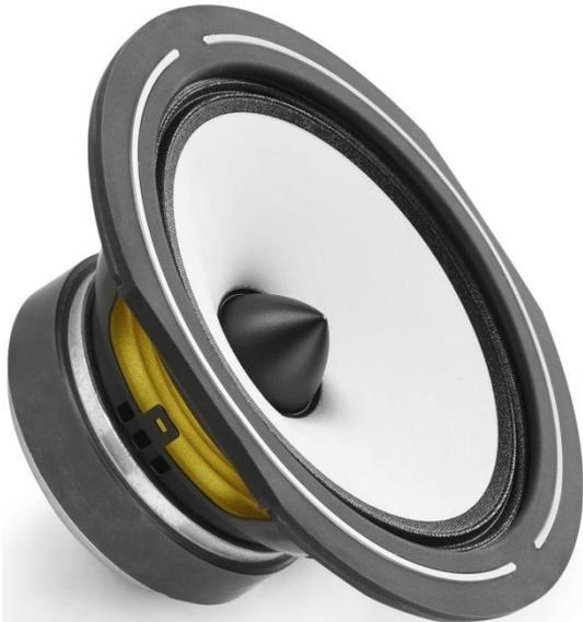
Der 16cm-Mitteltöner ist direkt aus der ESPRIT EZ-Linie abgeleitet und besteht, typisch für Hochwirkungsgradlautsprecher, aus Papier. Sein mitschwingender Phase-Plug sorgt für eine saubere und unter allen Bewegungsumständen gleichbleibende Abstrahlung der mittleren Frequenzen. Der sehr kräftige Magnetantrieb und die stark gespannte Zentrierspinne (im Bild gelb) sorgen für große Kontrolle. Dies entlastet schon an der Stelle der Schallentstehung den angeschlossenen Verstärker.
