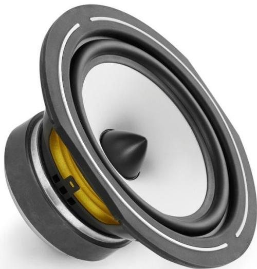
Der 16cm-Tiefmitteltöner ist direkt aus der ESPRIT EZ-Linie abgeleitet und besteht, typisch für Hochwirkungsgradlautsprecher, aus Papier. Sein mitschwingender Phase-Plug sorgt für eine saubere und unter allen Bewegungsumständen gleichbleibende Abstrahlung der mittleren Frequenzen. Der sehr kräftige Magnetantrieb und die stark gespannte Zentrierspinne (im Bild gelb) sorgen für große Kontrolle. Dies entlastet schon an der Stelle der Schallentstehung den angeschlossenen Verstärker.
