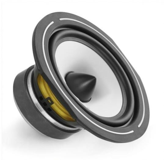
Der 13cm-Tiefmitteltöner ist direkt aus der ESPRIT EZ-Linie abgeleitet und besteht, typisch für Hochwirkungsgradlautsprecher, aus Papier. Sein mitschwingender Phase-Plug sorgt für eine saubere und unter allen Bewegungsumständen gleichbleibende Abstrahlung der mittleren Frequenzen. Der sehr kräftige Magnetantrieb und die stark gespannte Zentrierspinne (im Bild gelb) sorgen für große Kontrolle. Dies entlastet schon an der Stelle der Schallentstehung den angeschlossenen Verstärker.
