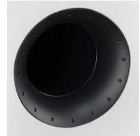
Die Anbringung der Öffnung auf der Front wird üblicherweise eher vermieden, da durch diesen Schallaustritt auch unerwünschte mittlere Frequenzen, die durch das Gehäuse vagabundieren ungewollt nach außen dringen.
