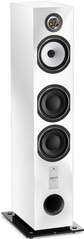
Das Gehäuse der Antal EZ ist im Innern mehrfach versteift und in zwei Kammern ausgeführt. Der Mitteltöner sitzt zusammen mit dem nach hinten geschlossenen Hochtöner in einem sehr großzügig bemessenen, geschlossenen Volumen. Die beiden Bässe arbeiten im unteren Abteil gemeinsam auf ein sehr tief abgestimmtes Bassreflexsystem. Dies erweitert die erreichbare untere Grenzfrequenz beträchtlich.
