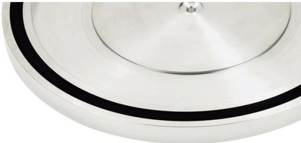
Der Hauptteller selbst besteht aus Aluminium, ist aus dem Vollen gedreht und wird am Rand durch eine schwingungsdämpfende Masse beruhigt. Dies verhindert unerwünschte Resonanzbildung in der Nähe des Tonabnehmers sehr effektiv. Aluminium ist antimagnetisch und verhindert somit eine magnetische Wechselwirkung mit den
