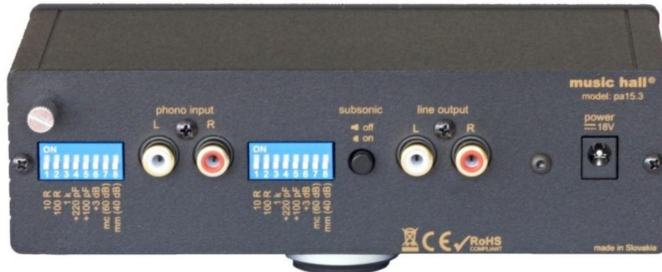
Die hohe Versorgungsspannung ermöglicht eine extrem hohe Ausgangsspannung von bis zu 10 V ohne Übersteuerung. Dies ist in dieser Preiskategorie einzigartig.
