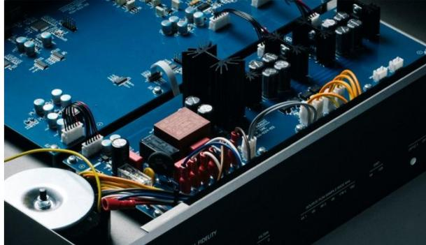
*Links der für digitale Audioanwendungen optimierte Ringkerntransformator. Die vordere Platine stellt jedem Schaltkreis die optimale und mehrfach stabilisierte Spannung zur Verfügung. Nicht im Bild, da direkt hinter dem Netzzugang: das EMI-Filter und der DC-Blocker.*
