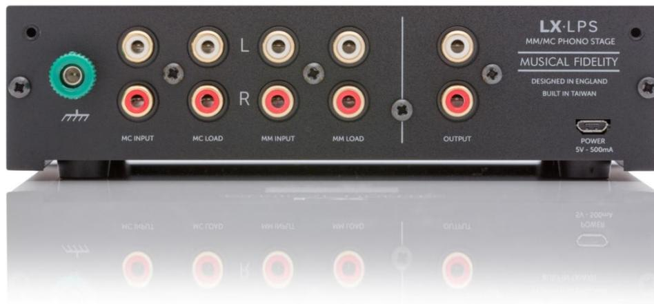
Der LX-LPS bietet die Möglichkeit, den Tonabnehmer korrekt abzuschließen. Sowohl für den Betrieb mit MM- als auch MC-Tonabnehmern gibt es an der Rückseite eigene Buchsen, in die RCA-Stecker mit den entsprechenden Kapazitäten und Widerständen gesteckt werden können. Die gebräuchlichen Standardwerte (für MM 47 pF / für MC 100 Ohm) sind in Form zweier Paare RCA-Stecker beigelegt.
