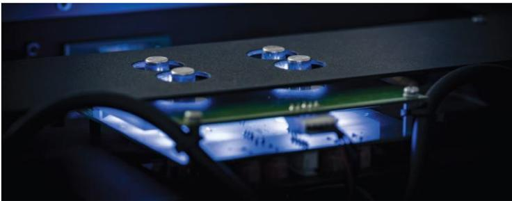
Der neue Nu-Vista PRE arbeitet in seiner Vorverstärkung mit insgesamt 8 Nuvistoren. Diese heben im Zusammenspiel mit der voll-diskreten Schaltung das Signal auf ein Niveau, dass für den Transport zum Endverstärker korrekt dimensioniert ist.
