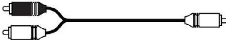
Verbinden Sie den Subwoofer unter Verwendung eines RCA-Y-Kabels wie abgebildet. Passen Sie die Lautstärke des Subwoofers und seine Übergangsfrequenz an.
