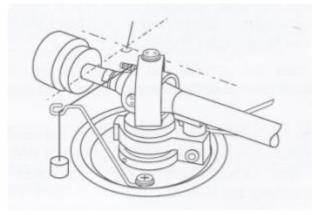
den Tonarm über eine Langspielplatte (Tonarmlift (8) angehoben lassen) in etwa in die Mitte der bespielten Fläche. Nun sollte das Tonarmrohr und der Faden zwischen Antiskatingfinger (5) und -Rute (4) in etwa im 90°-Winkel zueinander sein. Zur Korrektur darf die Rute in die korrekte Position gebogen werden.
