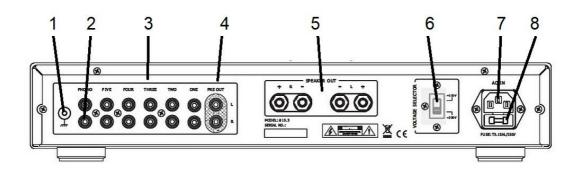
1 Erdungsanschluss für Plattenspieler 2 Phono-Eingang für Plattenspieler Hochpegeleingänge 3 Vorverstärkerausgang 4 5 Lautsprecheranschlüsse Wahlschalter für Netzspannung 6 7 Netzeingang 8 Netzsicherung
