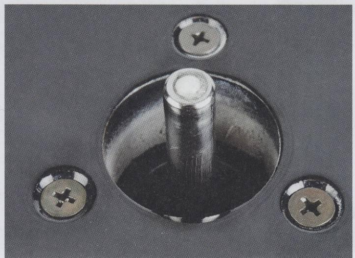
Inverslager, bestehend aus einer spiegelpolierten Stahlachse, Sinterbronze-Laufbuchse und polierter Keramik-Kugel.
