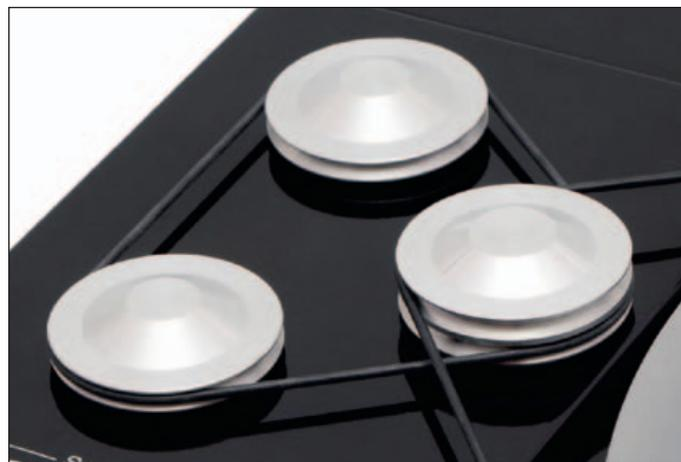
Auf diese unterste Chassis-Platte ist auch das Antriebssystem des mmf-11.1 montiert: ein Ensemble aus gleich zwei Synchronmotoren, die über große Pulleys zusammengekoppelt den Antriebspulley des Tellers antreiben. Ein durchaus eigenwilliges System, denn wie man sich unschwer vorstellen kann, liegt die Problematik im Gleichlauf der beiden Motoren. Um deren Steuerung kümmert sich ein Mikroprozessor, der zudem den Drehzahlwechsel auf 45 Umdrehungen via Knopfdruck ermöglicht.
