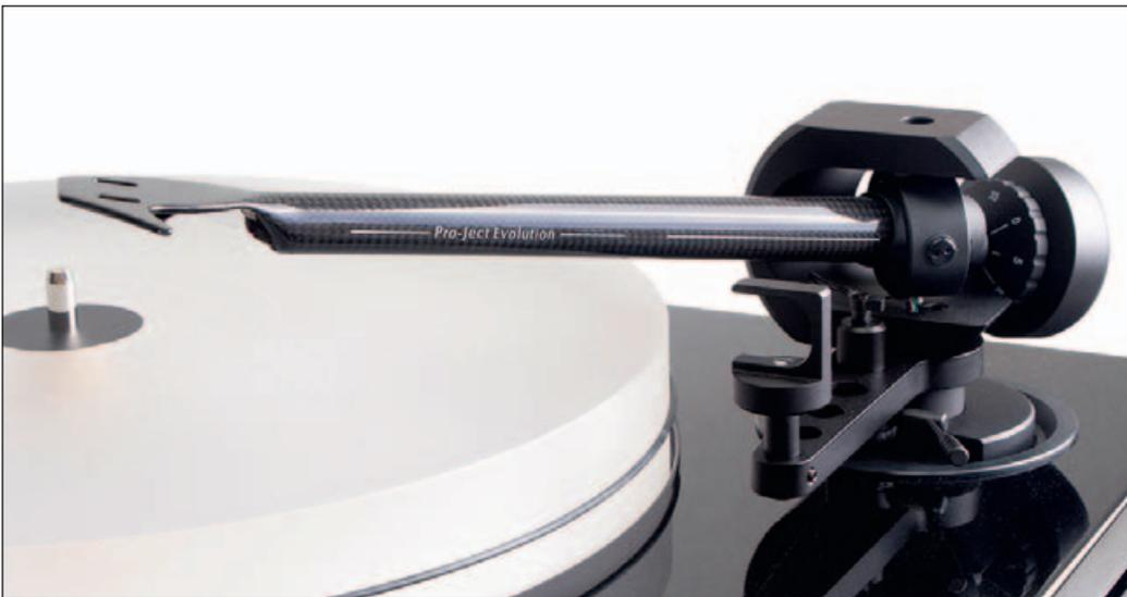
Bei dem von Produktionspartner Pro-Ject zugelieferten Evolution-Tonarm sind Armrohr und Headshell aus einem Stück Karbonfaser gefertigt. Vorbildlich dokumentiert Pro-Ject nicht nur die komplette Armgeometrie, sondern auch die effektive Masse (8,5 Gramm) des 9-Zöllers.
