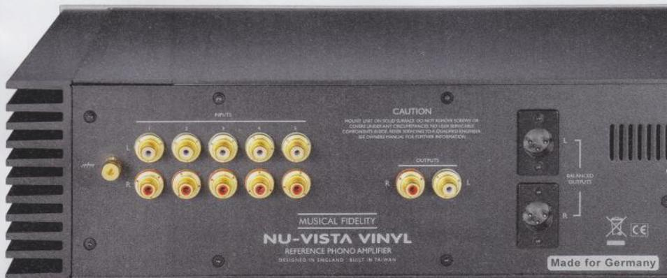
Fünf Paar Cinch-Eingangsbuchsen und die XLR- sowie Cinch-Ausgangsbuchsen. Im Gegensatz zu den Verstärkern und dem CD-Spieler fehlt hier die verkupferte Rückseite.
