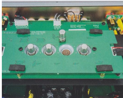
Klein, aber entscheidend: Vier Nuvistoren sind für den Klang des Gerätes mitverantwortlich
