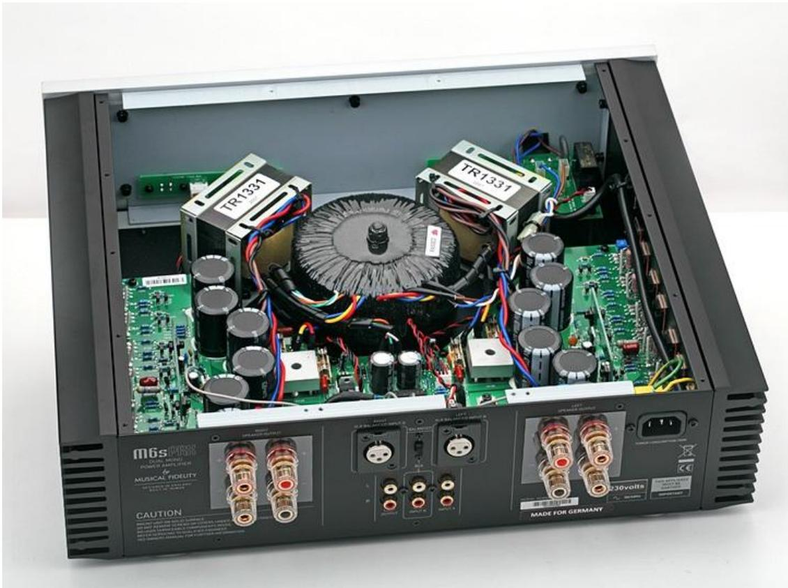
*Hinter der Ruhe liegt die Kraft: die M6s PWR-Endstufe liefert laut Messungen aus dem i-fidelity.net-Labor 2 x 336 Watt an 4 Ohm. Neben dem symmetrischen Schaltungslayout mit kürzest möglichen Signalpfaden hat die M6s PWR eine ungewöhnliche Form der Stromversorgung zu bieten: die sogenannte »Choke Regulated Power Supply«. Dieses Konzept war ursprünglich bei Röhrenverstärkern anzutreffen, kommt aber bei Musical Fidelity schon seit den späten 80er-Jahren zur Anwendung.*
