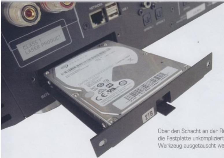
Über den Schacht an der Rückseite kann die Festplatte unkompliziert und ohne Werkzeug ausgetauscht werden
