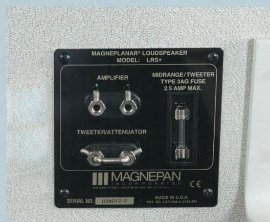
Am Tweeter/Attenuator passen wir mit Widerständen die Hochtongwiedergabe an
