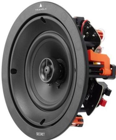
ICT5 ist ein runder Deckeneinbaulautsprecher mit einem 130 mm Chassis und einem verstellbaren Hochtöner mit 20 mm Seidenkalotte bei einem Gesamtdurchmesser von 216 mm. Das koaxiale Design bietet eine ausgezeichnete gleichmäßige Schallabstrahlung im gesamten Frequenzbereich (von 60 Hz bis 20 kHz) und eine Belastbarkeit von 110 W.
