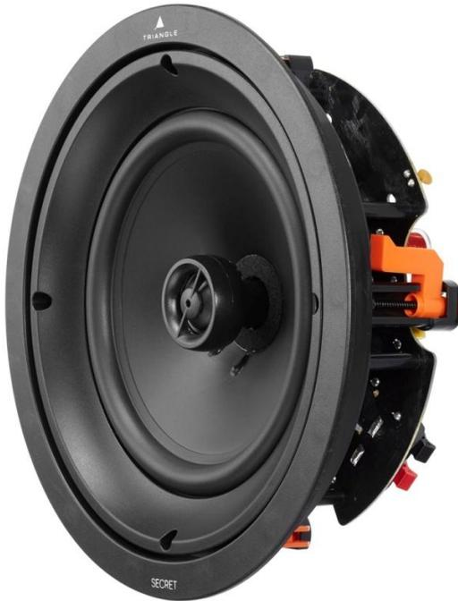
ICT8 ist ein runder Deckeneinbaulautsprecher mit einem 200 mm Chassis und einem verstellbaren Hochtöner mit 25 mm Seidenkalotte bei einem Gesamtdurchmesser von 284 mm. Das koaxiale Design bietet eine ausgezeichnete gleichmäßige Schallabstrahlung im gesamten Frequenzbereich (von 50 Hz bis 20 kHz) und eine Belastbarkeit von 160 W.
