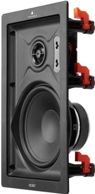
IWT7 ist ein rechteckiger Wandeinbaulautsprecher mit einem 170 mm Chassis und einem verstellbaren 25 mm Hochtöner mit Seidenkalotte. Dank der Pegeleinstellung des Hochtöners und des Mittel-/Tieftöners (-3 dB) können Sie den Lautsprecher an Ihren Raum anpassen. Seine 2-Wege-Konfiguration sorgt für einen klaren und differenzierten Klang im gesamten Frequenzbereich (55 Hz bis 20 kHz) und eine Belastbarkeit von 140 W.
