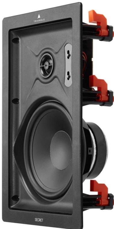
IWT8 ist ein rechteckiger Wandeinbaulautsprecher mit einem 200 mm Chassis und einem verstellbaren 25 mm Hochtöner mit Seidenkalotte. Dank der Pegeleinstellung des Hochtöners und des Mittel-/Tieftöners (-3 dB) können Sie den Lautsprecher an Ihren Raum anpassen. Seine 2-Wege-Konfiguration sorgt für einen klaren und differenzierten Klang im gesamten Frequenzbereich (40 Hz bis 20 kHz) und eine Belastbarkeit von 160 W.
