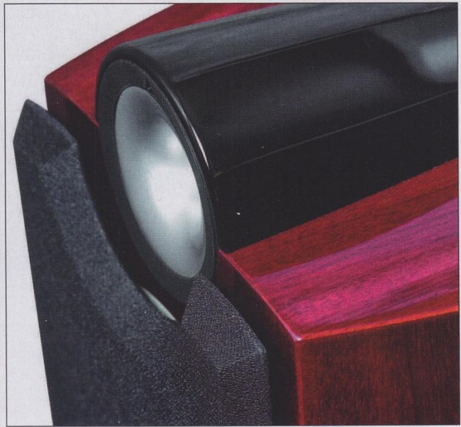
AUFGESETZT: Der Hochtöner ragt zur Hälfte aus dem Gehäuse. Eine Aussparung in der Abdeckung soll Klangveränderungen verhindern.
