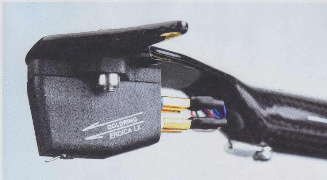
Goldrings MC-Tonabnehmer Eroica weist sehr starke Neodymmagnete auf, die Nadel besitzt einen „Line-Contact“-Schliff nach Gyger II. Mit 200 Ohm Abschluss ist dieser relativ „laute“ Abtaster zufrieden.
